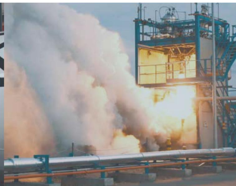
Ensayo de motor cohete de dos minutos de duración, el tiempo necesario para vuelo.
