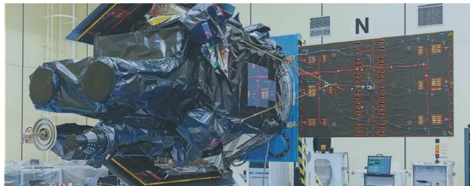
Ensayo de despliegue de los paneles solares de SEOSAT-Ingénio.
